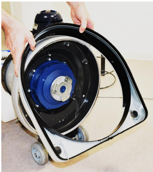
Abb. 8-9: Befestigung der Absaugeinheit am Maschinenkopf
