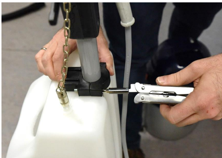
Abb. 8-72: Befestigen des Tanks an der oberen Halterung
